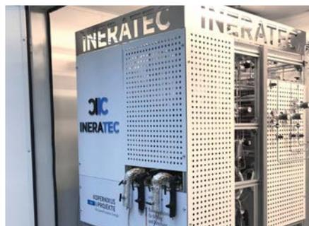
Die weltweit erste integrierte Power-to-Liquid-Versuchsanlage nutzt das CO<sub>2</sub> aus der Luft zur Synthese von Kraftstoffen.
